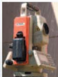
Intensitate ajustabila a firului cu plumb laser.
