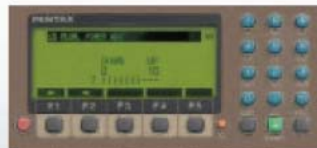
Intensitate ajustabila a firului cu plumb laser.
